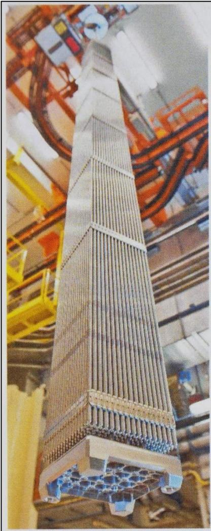
Le combustible nucléaire UNE ou MOX est conditionné sous forme de pastilles cylindriques d'un centimètre de diamètre et de hauteur environ, empilées dans des tubes en alliage de zirconium scellés aux deux extrémités.
